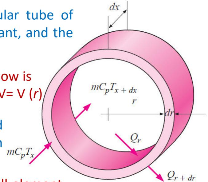
$$\dot{m} C_p T_x - \dot{m} C_p T_{x+dx} + \dot{Q}_r - \dot{Q}_{r+dr} = 0$$
